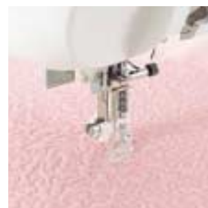
Il piedino per il quilting permette di vedere chiaramente la posizione dell'ago e di cucire liberamente lungo le linee del disegno.
